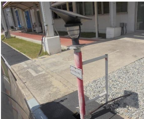
รูปที่ 14 การติดตั้งเสาวัดระดับน้ำในรางระบายน้ำฝน
