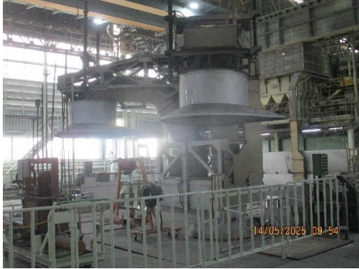
รูปที่ 1 Canopy Hood โรงงานเหล็กหล่อเสื้อสูบ
